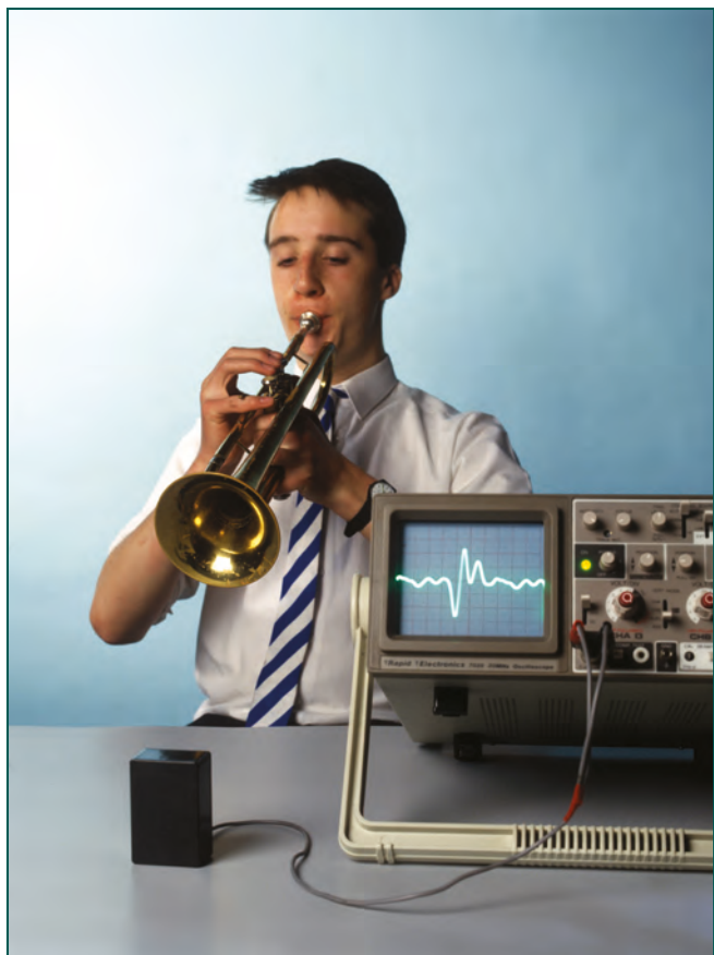
Figura 12.8 Për të parë lëkundjet që përbëjnë një notë muzikore, ato konvertohen në sinjal elektrik me anën e një mikrofoni dhe shfaqen në ekranin e një oshiloskopit. Gjurma që shohim në ekran paraqet ngjitjet dhe zbritjet e lëkundjeve që përbëjnë tingullin.
